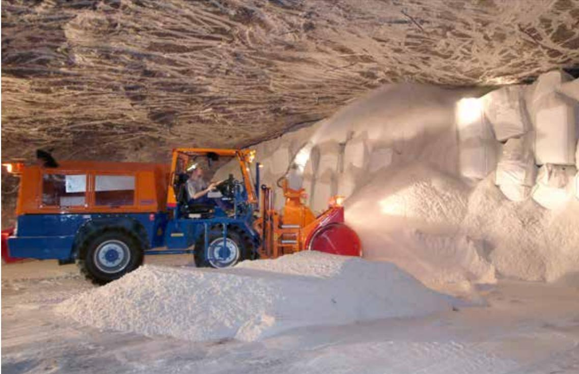
Abb. 2: Verwertung von Rauchgasreinigungsrückständen in Big-Bags in einer Untertageverwertungsanlage (hier Verschleudern der Hohlräume mit Steinsalz) (Foto: K+S)
