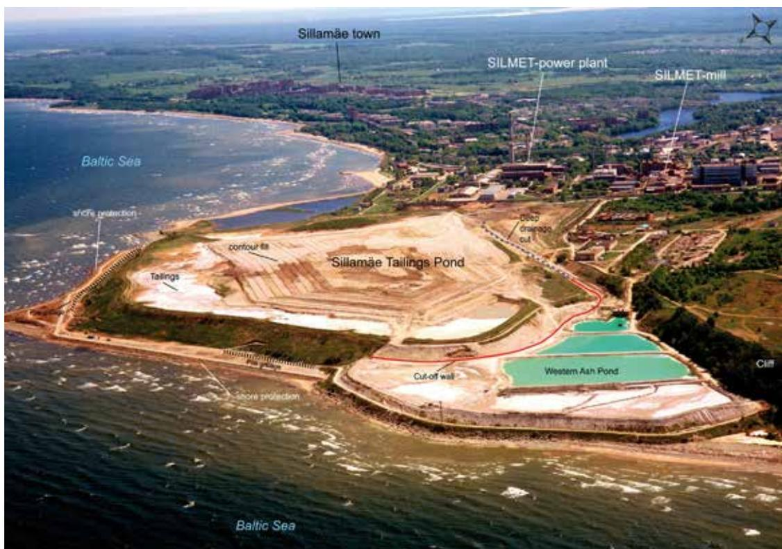
Abb 1: Sanierung der Absetzanlage Sillamäe im Jahr 2002
